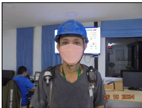
ภาพที่ 3.81 การตรวจวัดเสียงที่พนักงานสัมผัส บริเวณหม้อบดปูนซีเมนต์
