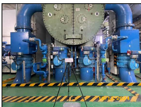
ภาพที่ 3.76 การตรวจวัดระดับเสียงของเครื่องจักร บริเวณปั้มทอส่งไอน้ำ
