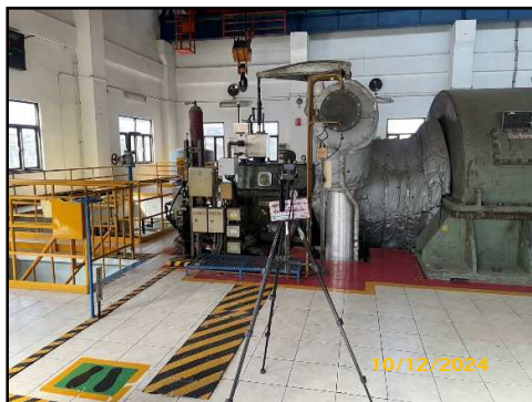
ภาพที่ 3.78 การตรวจวัดระดับเสียงของ เครื่องจักรบริเวณกังหันไอน้ำ
