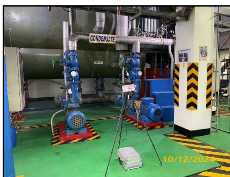
ภาพที่ 3.77 การตรวจวัดระดับเสียงของ เครื่องจักรบริเวณทอส่งไอน้ำ
