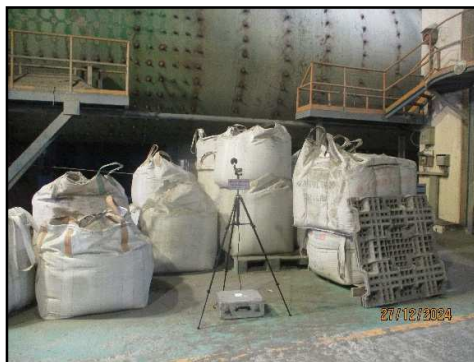
ภาพที่ 3.73 การตรวจวัดระดับเสียงของเครื่องจักร บริเวณหม้อบดปูนซีเมนต์
