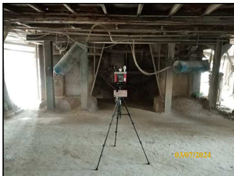
ภาพที่ 3.90 การตรวจวัดความร้อน บริเวณ Riser pipe หม้อเผา 5
