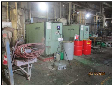
ภาพที่ 3.72 การตรวจวัดระดับเสียงของเครื่องจักร บริเวณ Compressor
