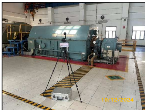
ภาพที่ 3.79 การตรวจวัดระดับเสียงของ เครื่องจักรบริเวณเครื่องกำเนิดไฟฟ้า
